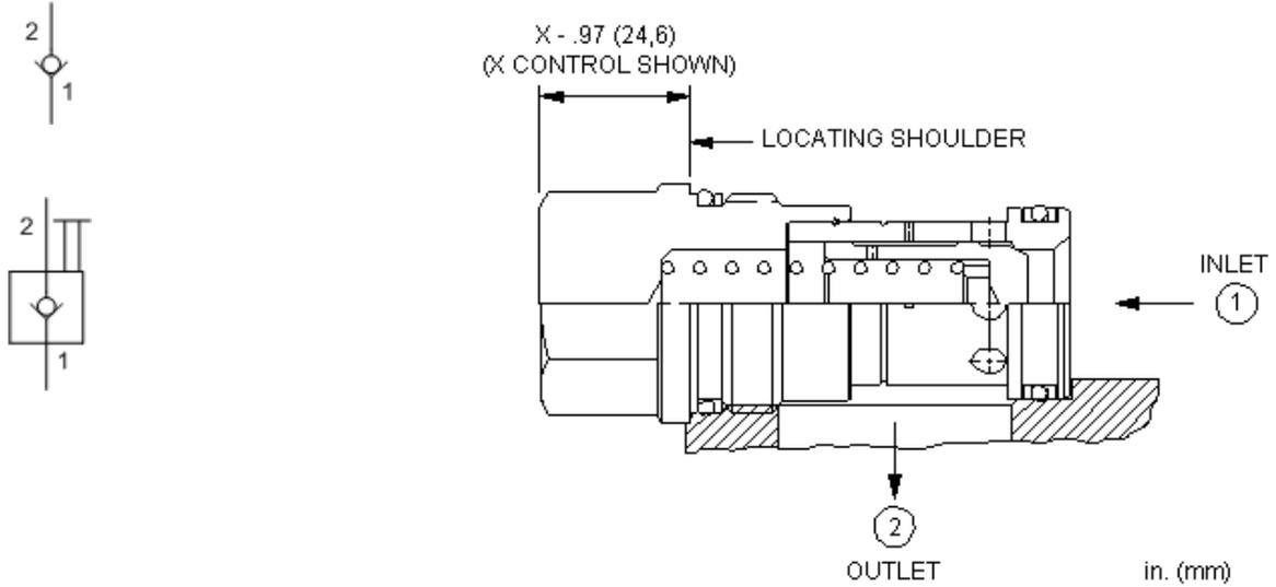
Rückschlagventile von SUN sind schaltende Ventile. Diese Version gibt den Volumenstrom von Anschluss 1 nach 2 frei und sperrt in umgekehrter Richtung.
